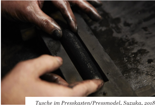
Tusche im Presskasten/Pressmodel, Suzuka, 2018
